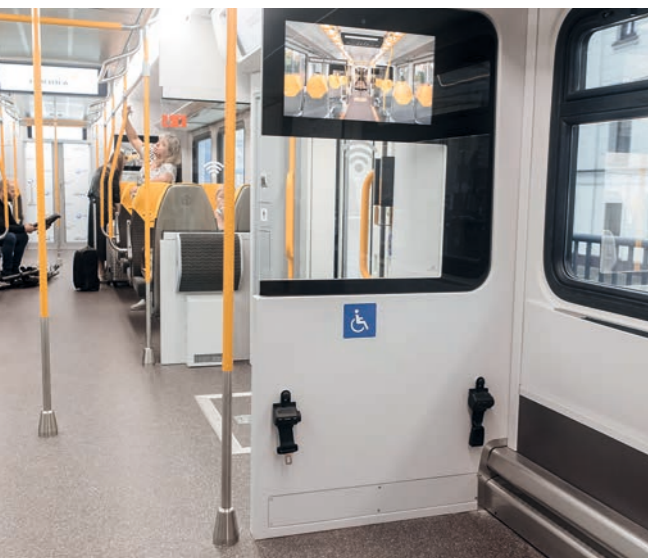
< В головных вагонах предусмотрены места для надежного крепления колясок
