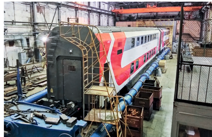
▼ Прочностные статические испытания двухэтажного пассажирского вагона-ресторана модели 61-4473
