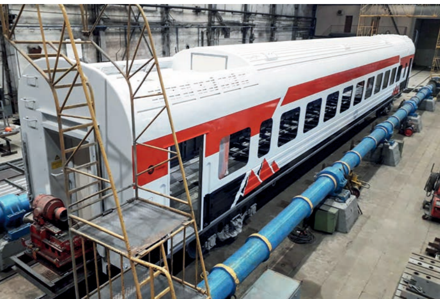
▲ Вибрационные испытания вагона для Египетских железных дорог
