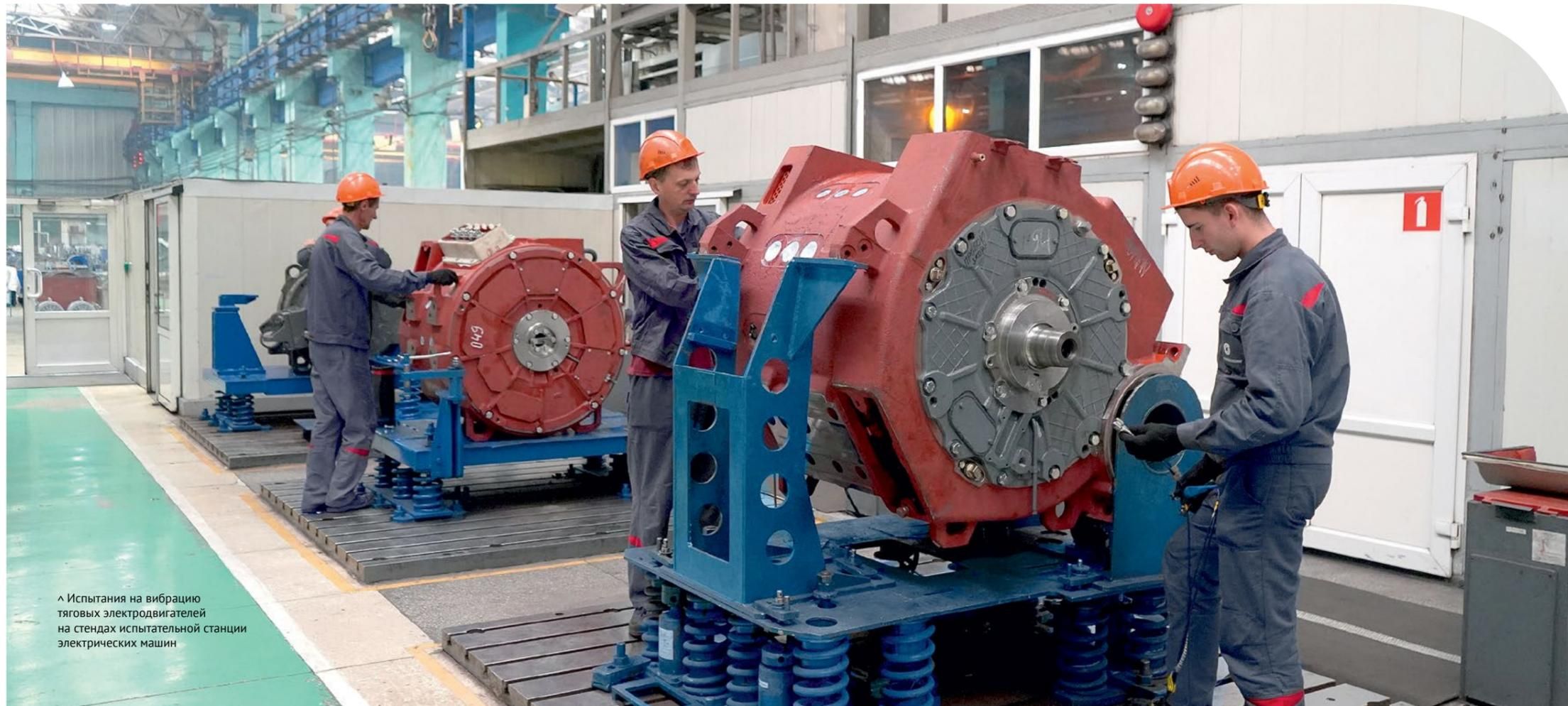
▲ Испытания на вибрацию тяговых электродвигателей на стендах испытательной станции электрических машин
