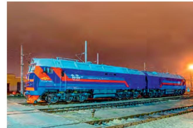
На брянских магистральных тепловозах 2ТЭ25КМ, которые поступают на УБЖД с 2017 года, для работы в монгольских условиях были модифицированы системы воздухоочистки и предусмотрена дополнительная защита от попадания пыли на оборудование. Также местные машинисты высоко оценили современную микропроцессорную систему, которая определяет оптимальную нагрузку дизель-генератора и тяговых машин, а также контролирует работу вспомогательного оборудования, что повышает эффективность локомотива в целом.
