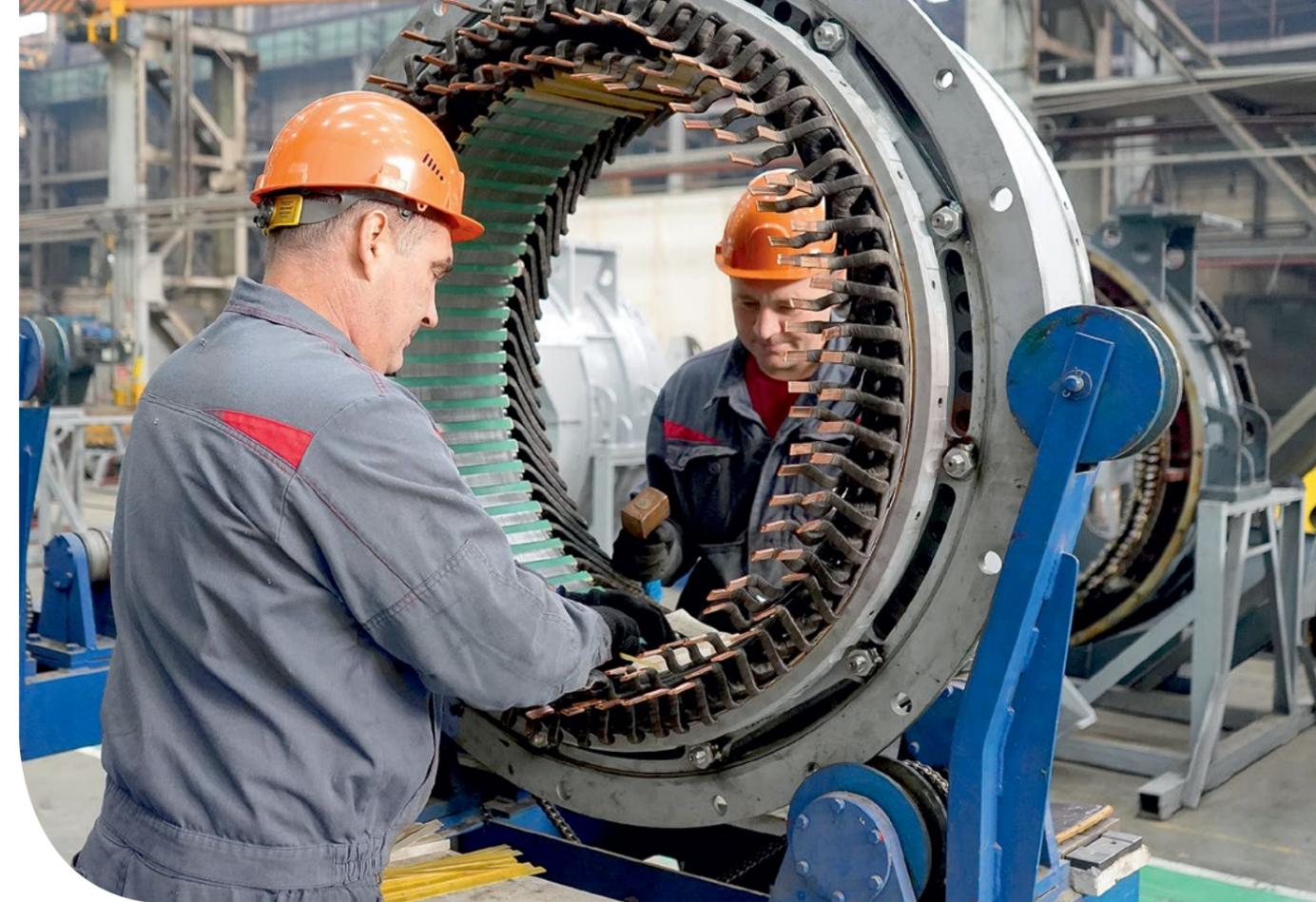
▲ Укладка катушек статора агрегата на участке сборки генераторов
